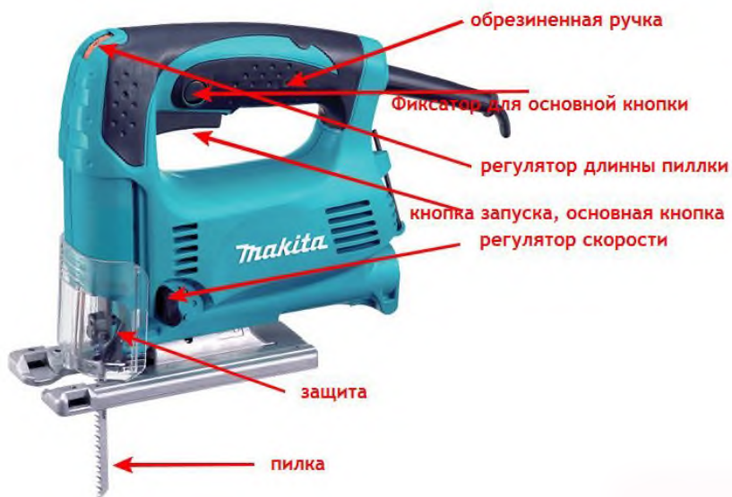
Рисунок 58 - Устройство электролобзика
