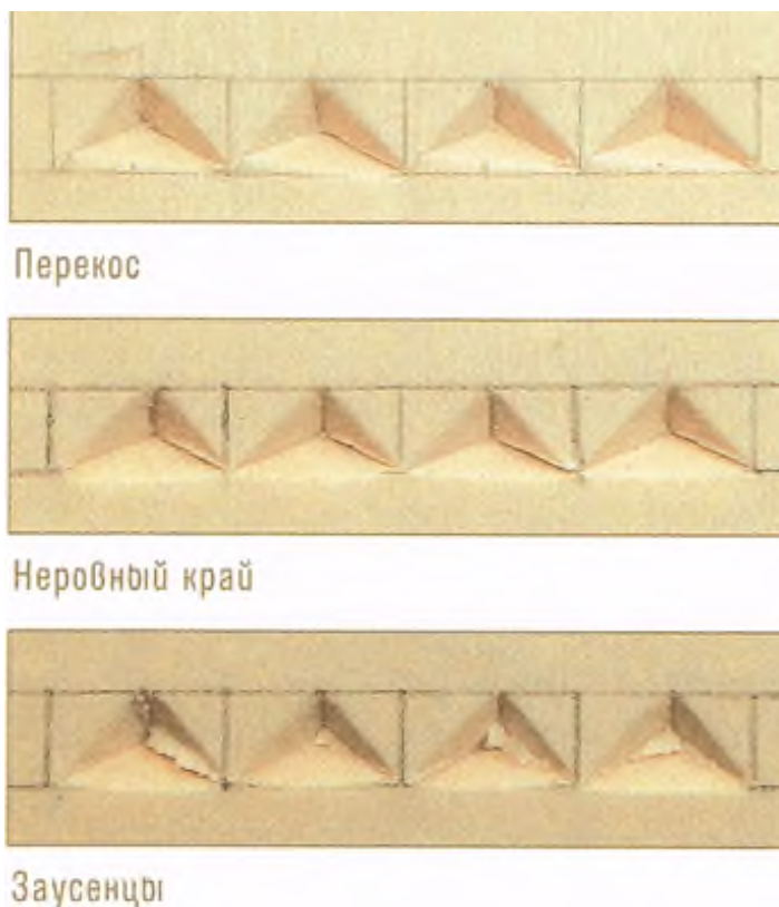
Рисунок 25 - Дефекты при вырезке трехгранных выемок
