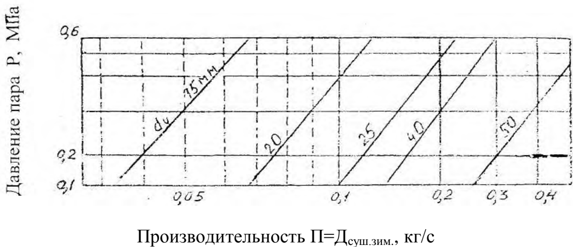
Рисунок Б.4 – Диаграмма для выбора диаметра условного прохода термодинамического конденсатоотводчика
