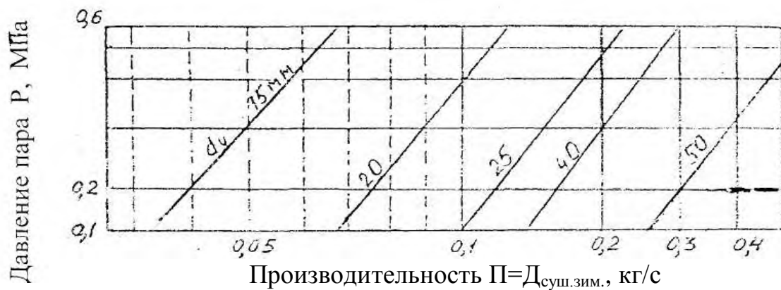
Рисунок 4 – Диаграмма для выбора диаметра условного прохода термодинамического конденсатоотводчика
