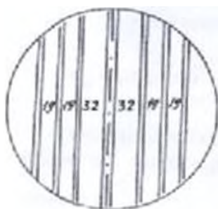
Рисунок 6- Схема постава бревна d=16 \text{ см}
