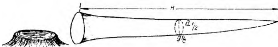
Рисунок 3 - Определение объема ствола по простой формуле срединного сечения
