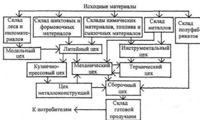
Рисунок 1.1 - Схема основных технологических процессов завода
