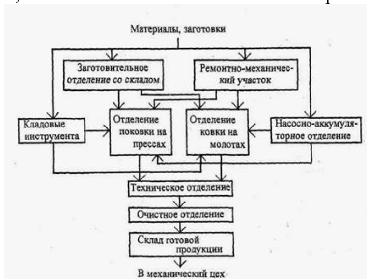
Рисунок 1.3 - Схема технологических потоков кузнечно-прессового цеха
