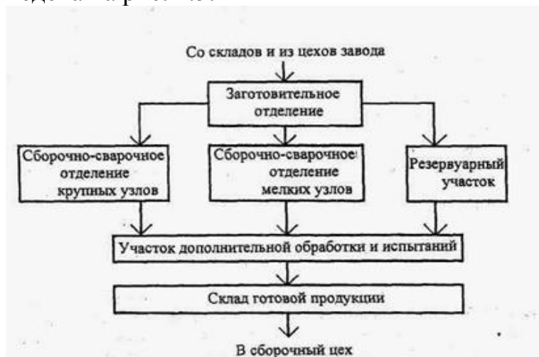
Рисунок 1.5 - Схема технологических потоков цеха металлоконструкций
