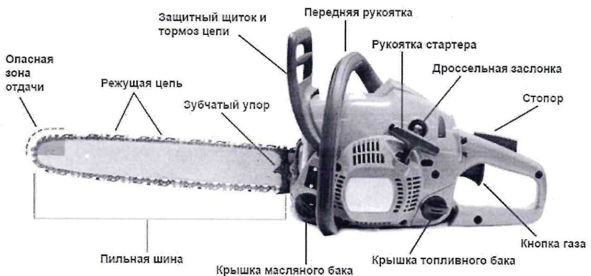
Рисунок 3 - Перечень основных деталей бензопил
